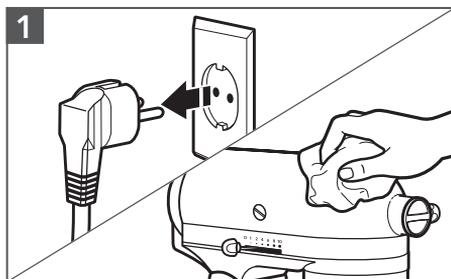
Stecken Sie die Küchenmaschine vor dem Reinigen immer aus. Wischen Sie die Küchenmaschine mit einem weichen, feuchten Tuch ab. Verwenden Sie keine Haushaltsreiniger bzw. kommerzielle Reinigungsmittel. Wischen Sie die Zubehörnabe regelmäßig ab, um alle Rückstände zu entfernen, die sich dort ansammeln können. Nicht in Wasser tauchen.
