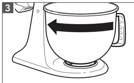
Die Schüssel auf die Aufspannplatte stellen und vorsichtig im Uhrzeigersinn drehen, bis sie einrastet.
