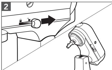
Entriegeln Sie den Motorkopf und heben Sie ihn an. Die Verriegelung\*\* rastet automatisch ein und fixiert den Motorkopf.
