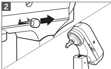
Entriegeln Sie den Motorkopf und
