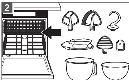
Schüsseln, Spritzschutz\*, Flachrührer\*, Flexi-Rührer\*, Teigrührer\* und Schaber\*\* sowie Kneithaken sind spülmaschinenfest im Oberkorb oder sollten in heißem Seifenwasser gründlich gereinigt und anschließend abgespült und abgetrocknet werden. Belassen Sie die Flachrührer zur Aufbewahrung nicht an der Welle.
