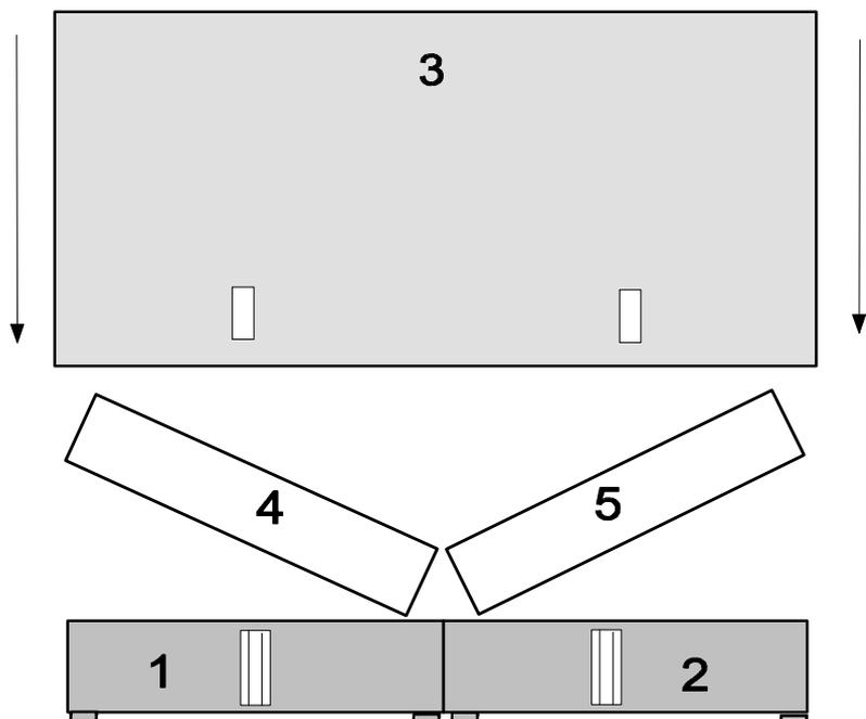
3. Lüftungsgitter einsetzen
