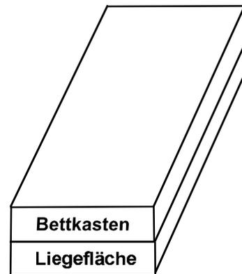
2. **Transportsicherung (Schraube) herausdrehen und Bettkasten nach Unten drücken. Anschließend Bettkasten vorsichtig öffnen und Bett auf den Bettkasten stellen.**
