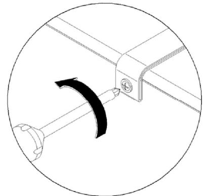
**Achtung! Bettkasten kann ohne Gegendruck nach Entfernen der Transportsicherung aufspringen!**
