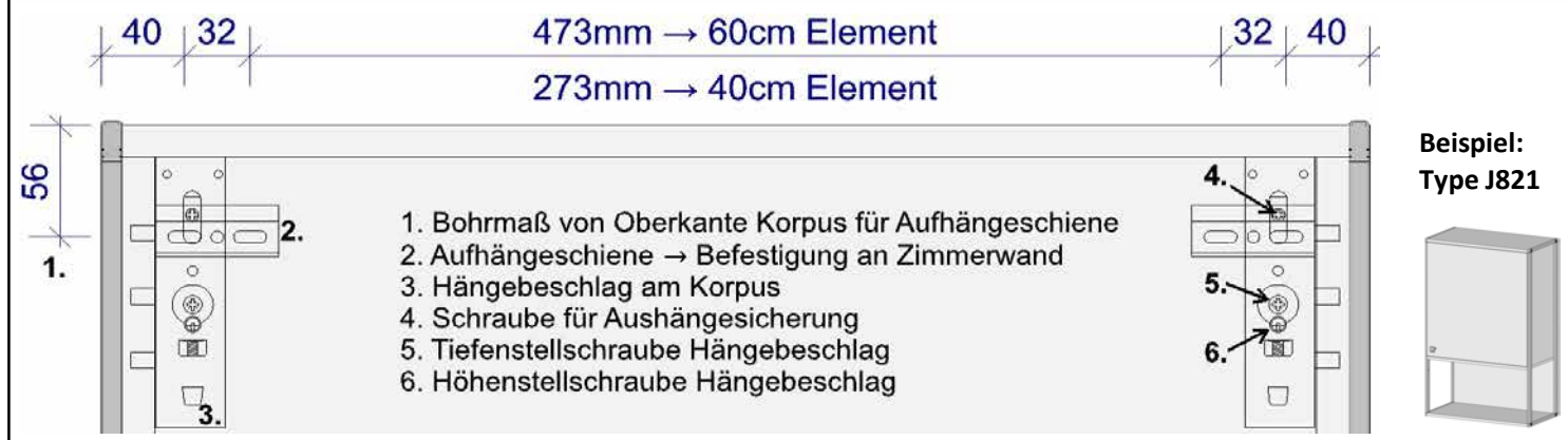
Abbildung 2: Bohrmaße für Aufhängeschienen Teil-Nr. 50811 mit Elementbreite 40cm
