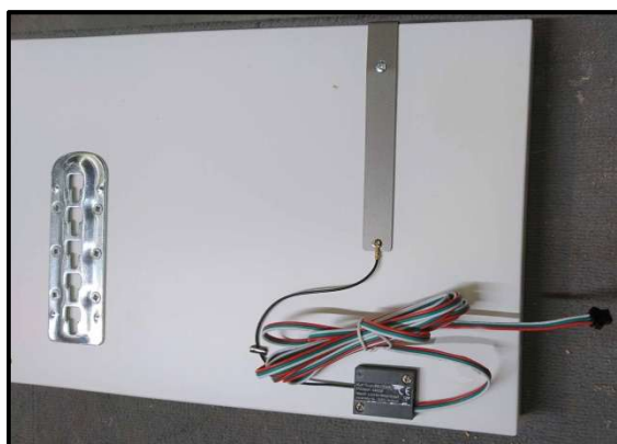
Winkelschalter an Bettseite verbaut
