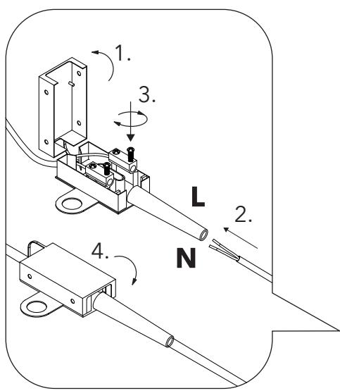
Weißen Kabelschutz vorsichtig mit Schlitzschraubenzieher öffnen.
