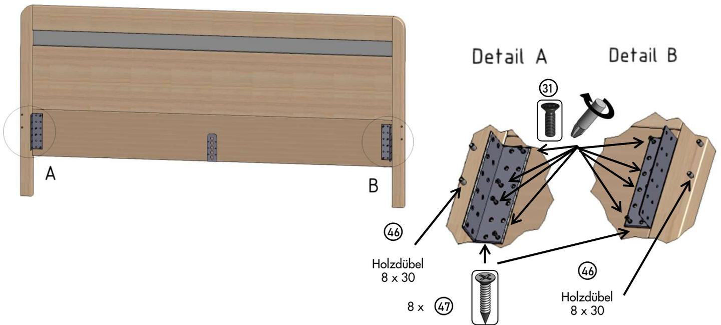
2. Befestigungswinkel (30) mit vier Euro-Schrauben (31) und acht Schrauben 4x20 (47) am Fußteil montieren und Holzdübel (46) einstecken.
