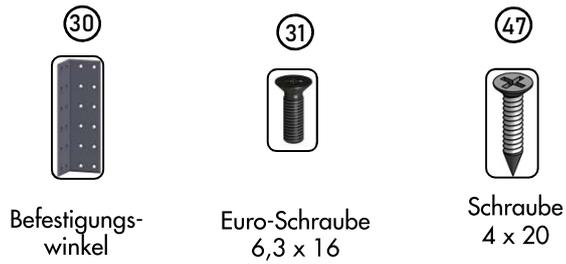
3. Bettkopfteil mit Befestigungswinkel (30) mit vier Euro-Schrauben (31) und acht Schrauben 4 x 20 (47) mit den Bettseiten verbinden.
