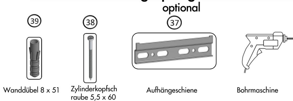
1. Bohrung  $\varnothing$  8mm für Aufhängeschienen bohren, Dübel (39) einstecken und Schienen mit Zylinderkopfschrauben (38) befestigen.
