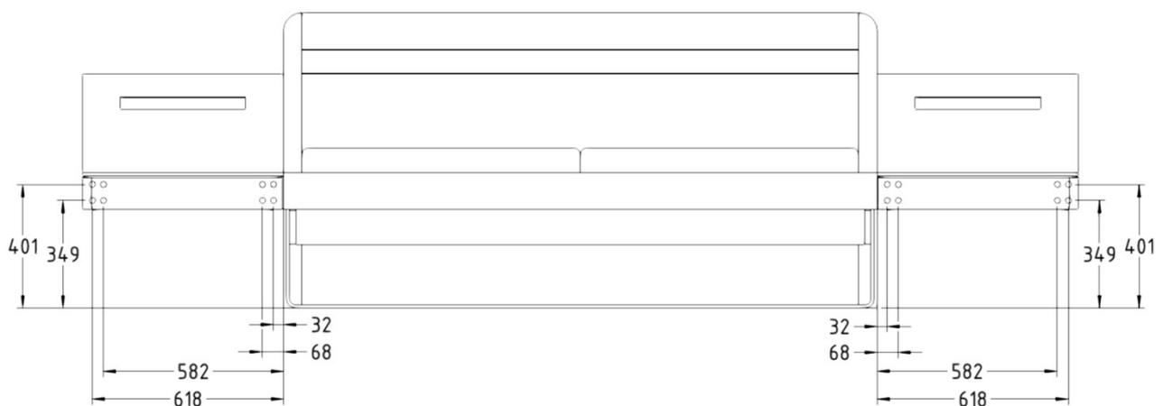
2. Nachtkonsolen an Aufhängeschienen befestigen und ausrichten, anschließend die Konsole mit der Bettseite verschrauben.
