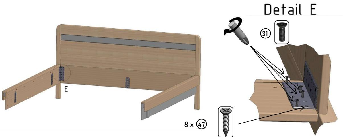
4. Bettfußteil mit Befestigungswinkel (30) mit vier Euro-Schrauben (31) und acht Schrauben 4 x 20 mit den Bettseiten verbinden.
