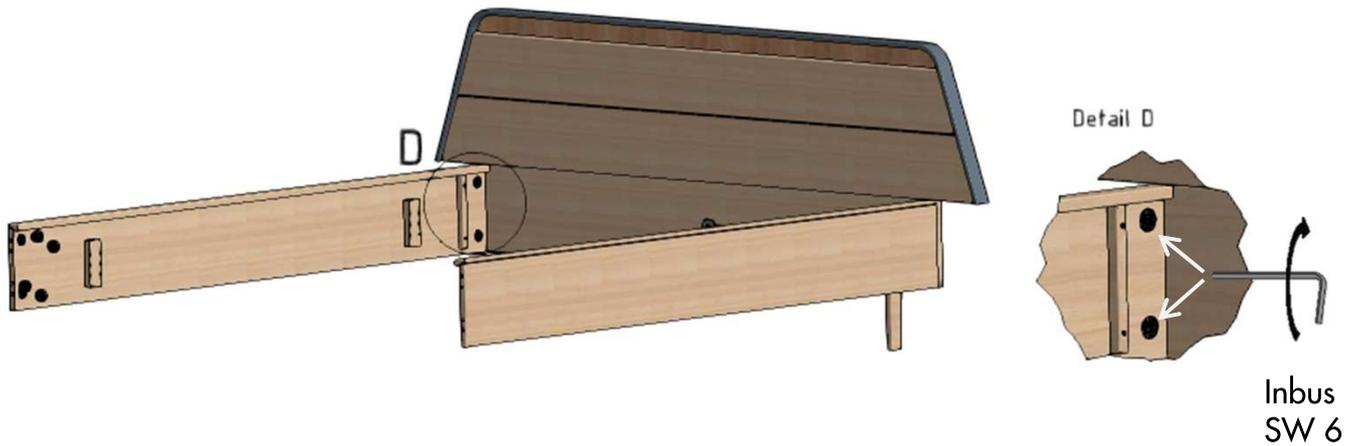
4. Bettfußteil mit den vormontierten Gewindebolzen und Dübeln an die Bettseiten stecken und mit dem Maxi-Fix-Beschlag montieren.
