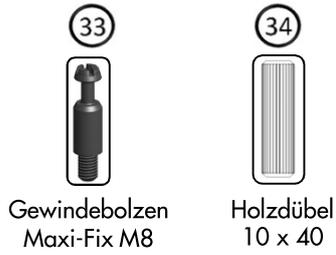
1. Gewindebolzen (33) im Kopfteil vormontieren und Holzdübel (34) einstecken.
