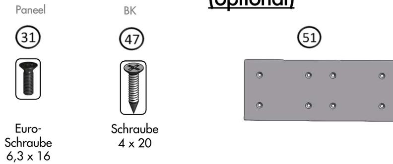
1. Panel von vorne an das Bettkopfteil ansetzen, hierbei darauf achten dass das Panel unten bündig mit dem Bettkopfteil abschließt und der Metallboden sich in die Nut auf der Vorderseite einfügt. Die Metallplatte mit 4 Euro-Schrauben 6,3x13 (31) mit dem Panel verschrauben und die Metallplatte mit 4 Schrauben 4x 20 (47) an dem Bettkopfteil verschrauben.
