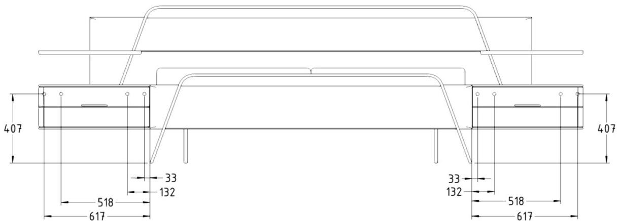
2. Nachtkonsolen an Aufhängeschienen befestigen und ausrichten, anschließend die Konsolen mit der Bettseite verschrauben.
