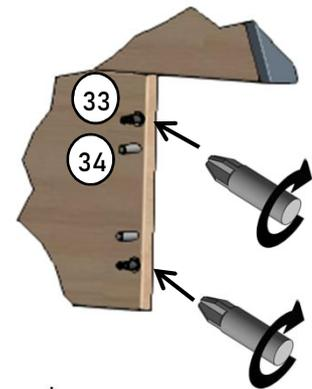
2. Gewindebolzen (33) im Fußteil vormontieren und Holzdübel (34) einstecken.
