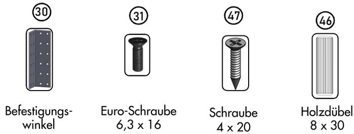
1. Befestigungswinkel (30) mit vier Euro-Schrauben (31) und acht Schrauben 4x20 (47) am Bettkopfteil montieren und Holzdübel (46) einstecken.
