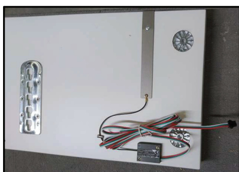
Wechselschalter an Bettseite verbaut
