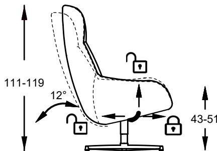
↑ Réglage de la hauteur d'assise : actionner le levier vers le haut sans exercer de pression sur le siège
