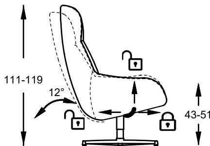
↑ Sitzhöhen Verstellung: **Sitz entlasten**, Hebel nach oben ziehen
