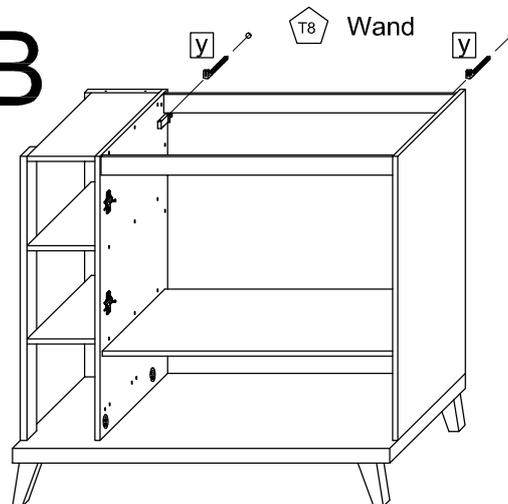
**T6** Die Schrankaufhänger dienen zur Kippsicherung des Schrankes und müssen grundsätzlich montiert werden.
