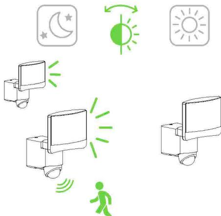
**De-activate sensor override mode** Deaktivieren Sie den Sensor-Override-Modus/Désactiver le mode prioritaire du capteur
