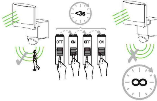
**Activate sensor override mode** Aktivieren Sie den Sensor-Override-Modus/Activer le mode prioritaire du capteur
