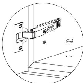
Nach dem Justieren bitte die Bohrlöcher mit den Abdeckkappen verschließen.
