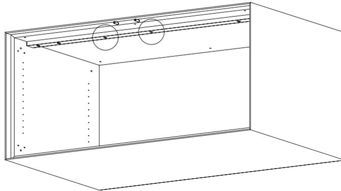
Alle Boxen B 120 cm sind werkseitig mit einer Verstärkungsschiene unter dem oberen Boden ausgestattet. Die Verstärkungsschienen über die Verstellerschrauben vorspannen und die Böden ausrichten (Inbus 3 mm).
