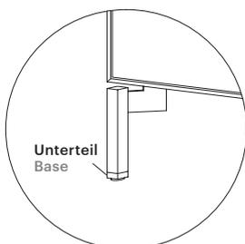
Durch das Drehen der Unterteile können die Füße justiert werden. Die Füße bitte so einstellen, dass die Boxen waagrecht stehen.
