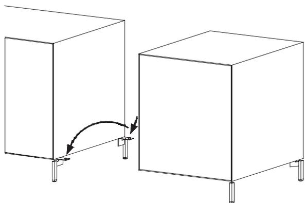
Die zweite Box auf die Arretierungsdorne der überstehenden Grundplatte der Kombifüße aufsetzen und einrasten lassen.
