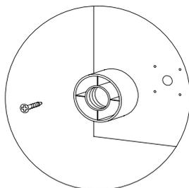
Der untere Boden der Box ist zur Montage von höhenverstellbaren Gleitfüßen aus schwarzem Kunststoff vorbereitet.
