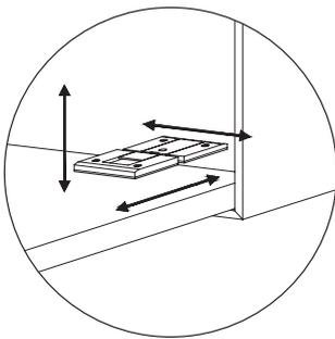
Klappen sind über die 3-dimensionale Bandverstellung zu justieren.
