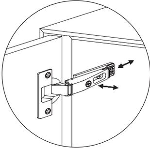
Türen über die 3-dimensionale Bandverstellung justieren (Abdeckkappen der Topfbänder entfernen).
