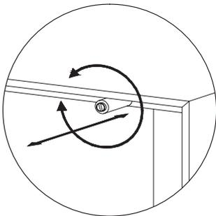
Über den Magnetschnäpper durch drehen, die Tür- und Klappenebene und den Rücksprung der Front zur Box justieren.
