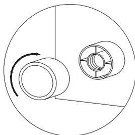
Das Unterteil des Gleitfußes ist in den vorgebohrten Löchern zu verschrauben.
