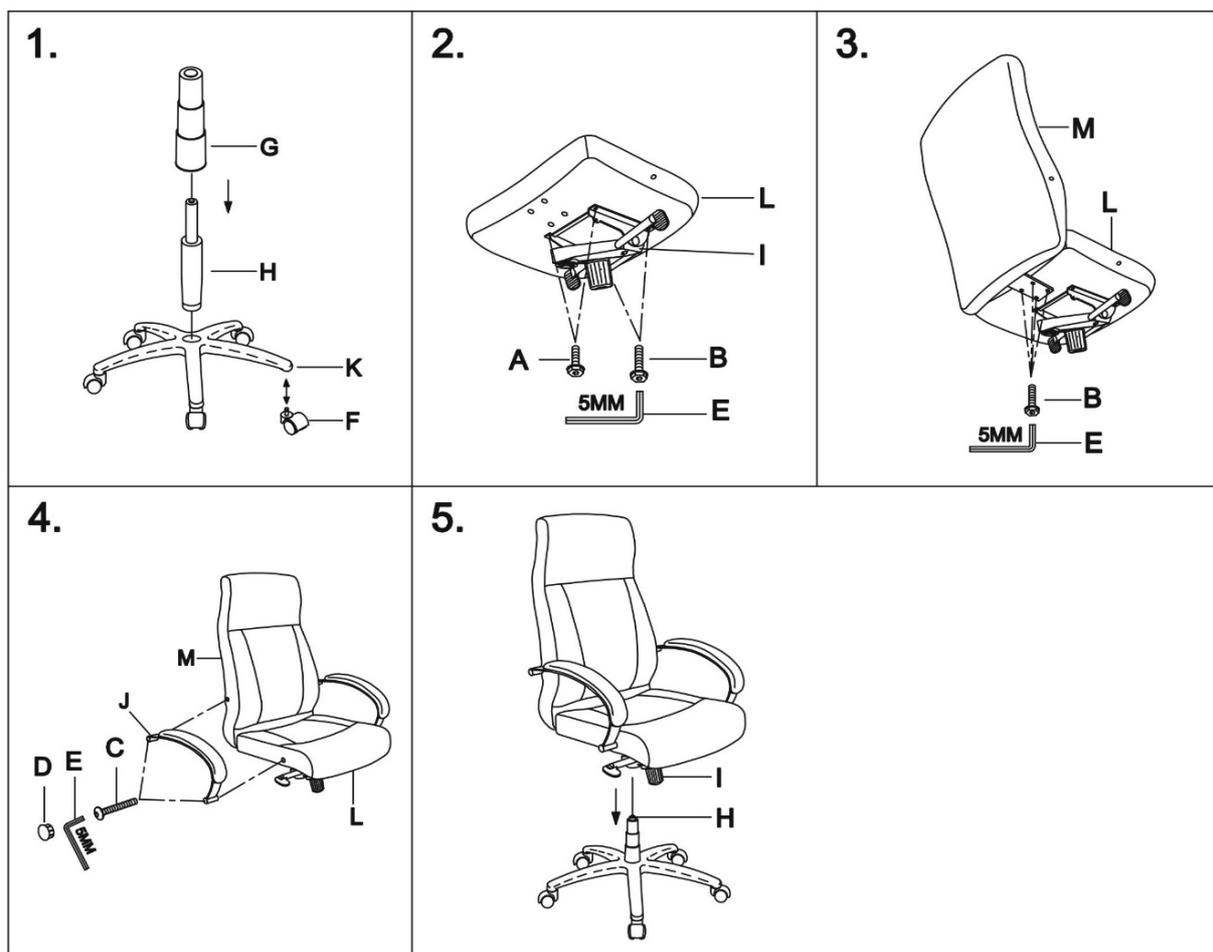
Nach der Montage setzen Sie sich bitte mehrfach hintereinander auf den Drehstuhl, damit sich die Verbindung zwischen Sitz, Gaslift und Fusskreuz verfestigt.
