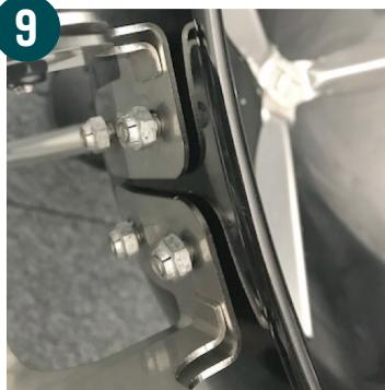
Hier können Sie die losen Bolzen sehen: Das Scharnier kann leicht nach unten und oben entlang der Schlitze bewegt werden.
