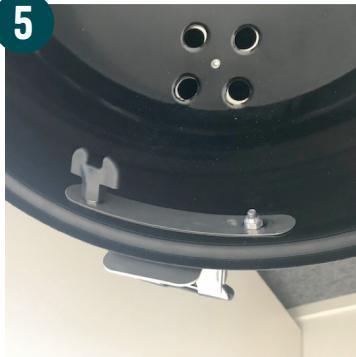
Die Hinterlegplatte des Deckels geht in den Deckel rein. Setzen Sie die Schrauben von außen ein (der U-förmige Griff sollte nach oben zeigen, wenn der Deckel umgedreht wird) und ziehen Sie die Bolzen von innen fest.
