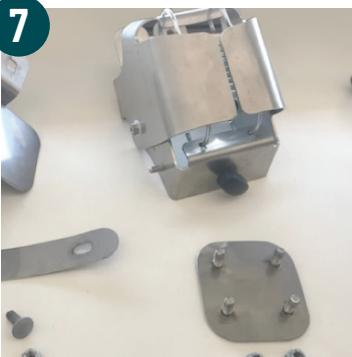
Nehmen Sie den Kessel und die Scharnier Teile für den Kessel.
