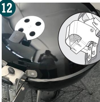
Stellen Sie sicher, dass der Deckel flach auf dem Kessel ist. Halten Sie den Deckel geschlossen und justieren Sie das untere Scharnier (falls notwendig), bevor Sie die Schrauben anziehen. Die Fehlerbehebung ist in den nächsten Punkten erklärt.
