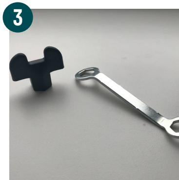
Dies sind die Werkzeuge die bereits für den Aufbau des Deckels enthalten sind. Alternativ können Sie einen Ringschlüssel Größe 11 verwenden
