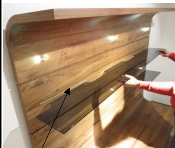
Bild 14: Glasboden zum Schluß in die vorgesehene Ausfräsung einschieben
