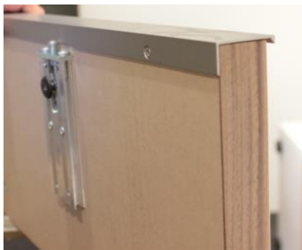
Bild 15: Beschlagmontage bei der Variante Typ "C" (ohne Rundung) erhält eine Abschlußleiste
