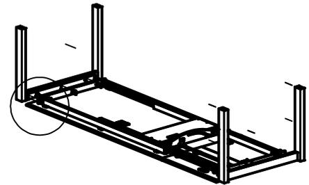
**Im Vorder -und Hinterbock sind unterschiedliche Bohrungen enthalten-** Die Böcke an die richtige Seite (Feste oder Auszugsseite) mit den mitgelieferten Schrauben montieren.
