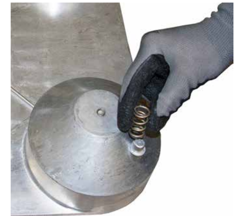
Bild/Picture 3.1 Druckfedern aufstecken, Detail
