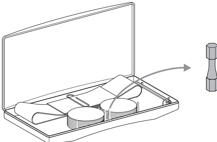
(D) Der Überlastschutz kann bei Bedarf ganz leicht ersetzt werden.
