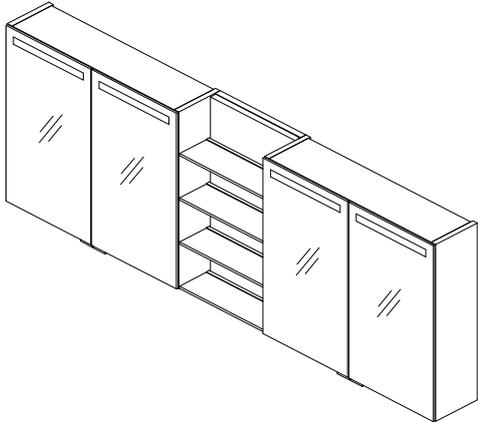
Vor der Wandmontage muss man die zwei Korpuselemente hinten mit 4 Stück 40mm Spax Schrauben zusammenschrauben.
