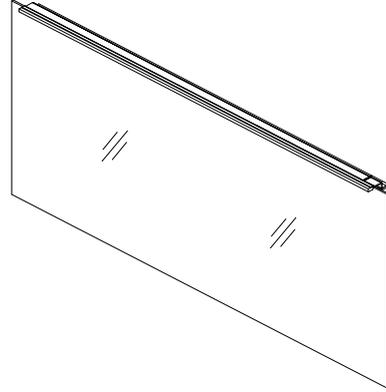
1. Holz-Montageleisten waagrecht auf gewünschte Position an Wand befestigen. Montagezubehör ist nur für festes Mauerwerk geeignet.
