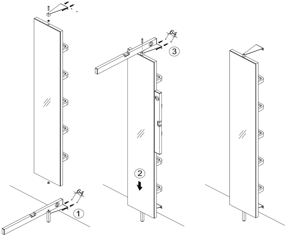
1. Drehbeschlag unten waagrecht auf gewünschte Position an Wand befestigen.
