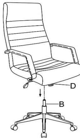
Nach der Montage setzen Sie sich bitte mehrfach hintereinander auf den Drehstuhl, damit sich die Verbindung zwischen Sitz, Gaslift und Fusskreuz verfestigt.
