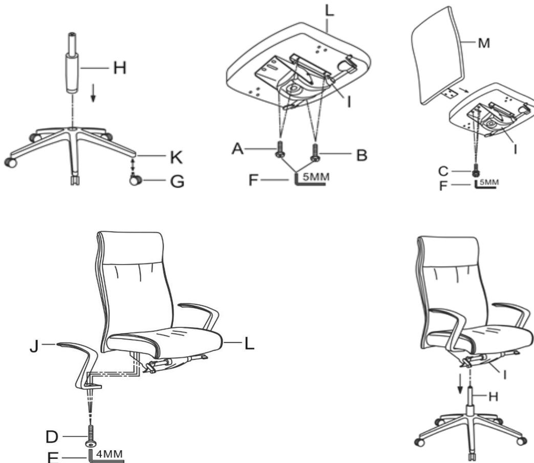
Nach der Montage setzen Sie sich bitte mehrfach hintereinander auf den Drehstuhl, damit sich die Verbindung zwischen Sitz, Gaslift und Fusskreuz verfestigt.
