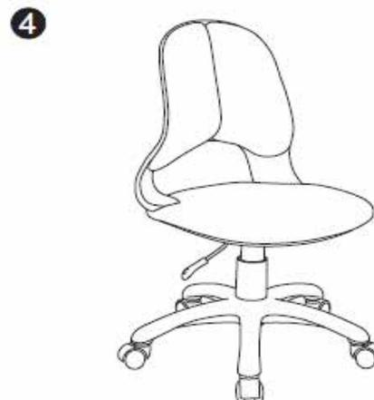
Nach der Montage setzen Sie sich bitte mehrfach hintereinander auf den Drehstuhl, damit sich die Verbindung zwischen Sitz, Gaslift und Fusskreuz verfestigt.
