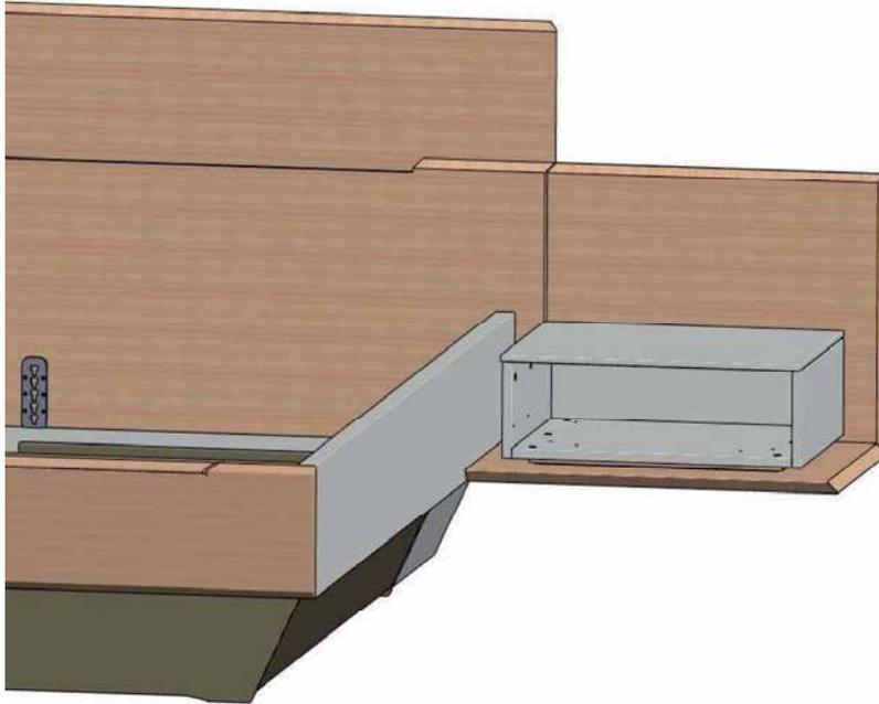
2. Daraufhin wird die Aufsatzkonsole so ausgerichtet, so dass diese hinten vor dem Paneel steht und einen seitlichen Abstand von ca. 60 mm zur Bettseite aufweist. Als Anhalt dient die Verbindungsfuge zwischen Bettkopf und Ansatzpaneel.
