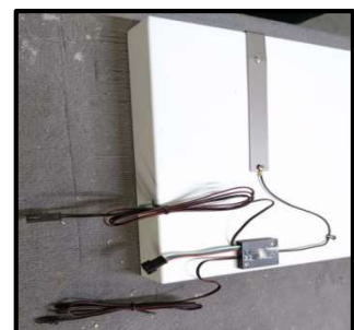
Winkelschalter an Bettseite verbaut
