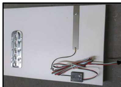
Winkelschalter an Bettseite verbaut
