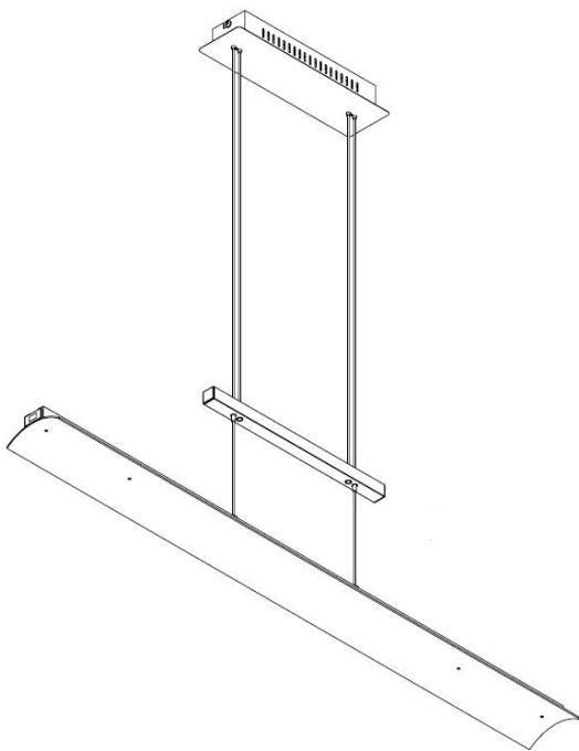
**Lösung:** Den Inneren Draht etwas heraus-schieben bis der Stopper sichtbar wird. Diesen Stopper mithilfe der mitgelieferten Imbusschlüssel auf dem Draht verschieben bis der Verstellbalken komplett parallel zur Leuchte hängt. Der überstehende Draht kann mit einer Schere abgeschnitten werden.
