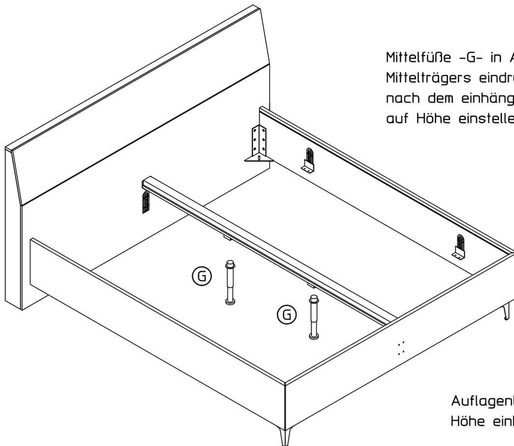
Mittelfüße -G- in Aufnahme des Mittelträgers eindrücken und nach dem einhängen durch drehen auf Höhe einstellen
