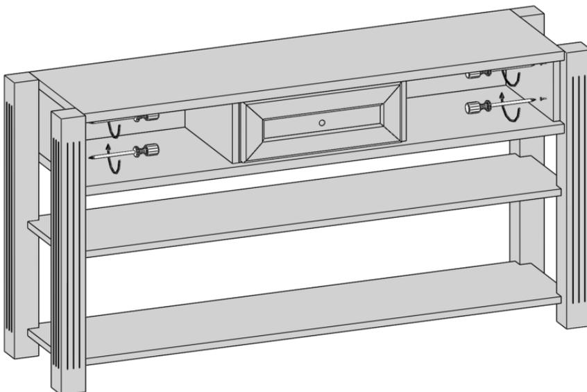
Hängen Sie den linken und rechten Schubkasten aus, sodass der Einhängekorpus noch mit den Füßen verschraubt werden kann. Nutzen Sie dazu die vorgebohrten Löcher mit den Schrauben 4x50mm.
