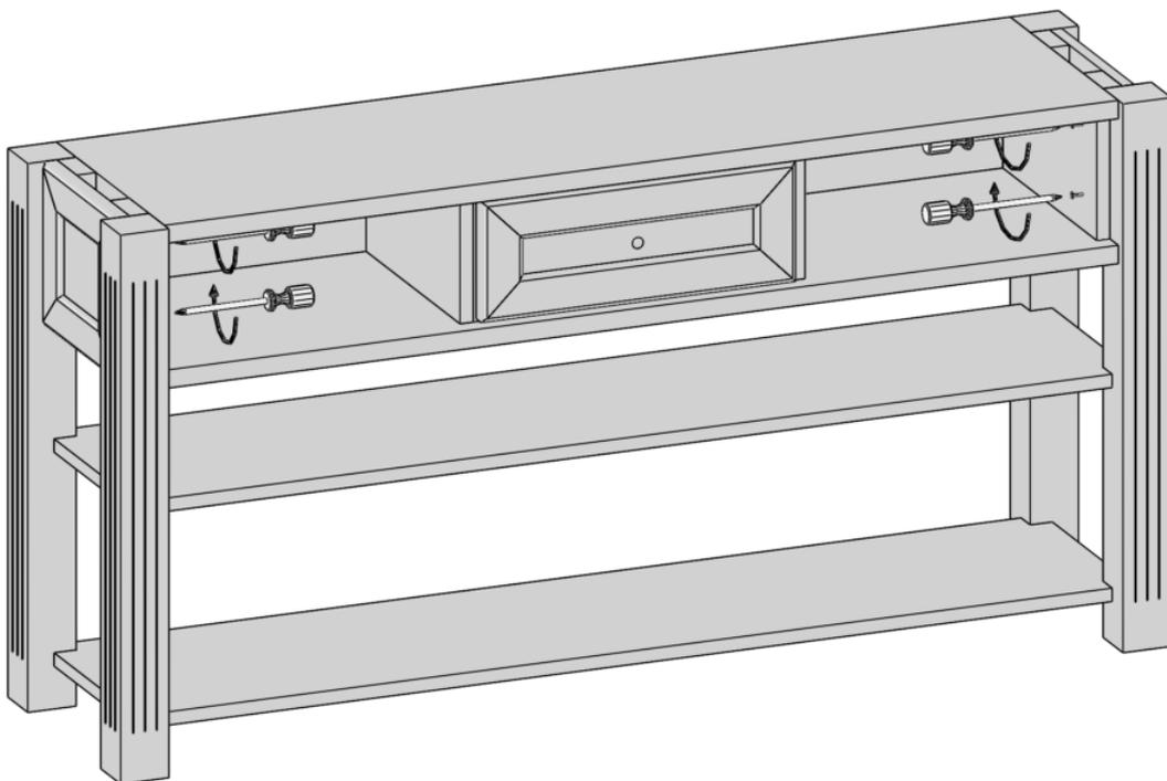
Halten Sie die Außenseite zwischen die FüÙe und an der Oberkante des Korpus bündig. Nun verschrauben Sie diese mit den mitgelieferten Schrauben 4x50mm.
