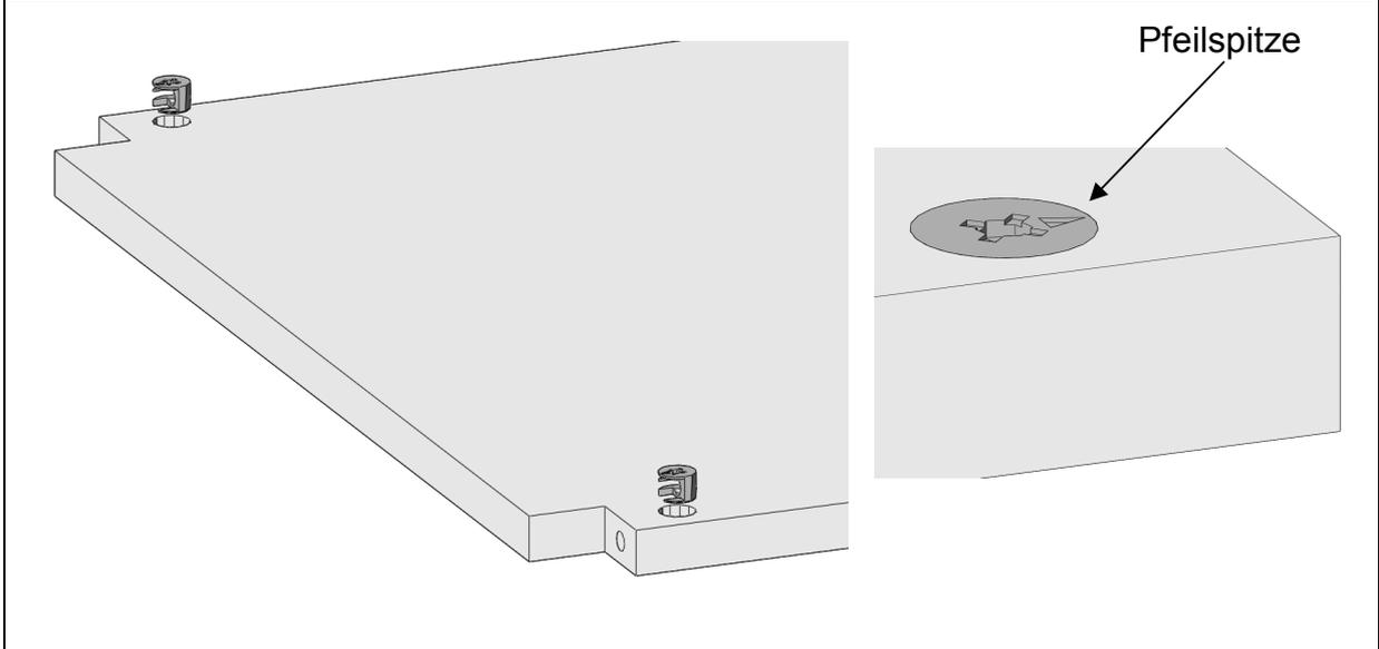
Drücken Sie die Excentergehäuse in die vorgebohrten Löcher. Achten Sie darauf, dass die Pfeilspitze nach vorn zeigt.
