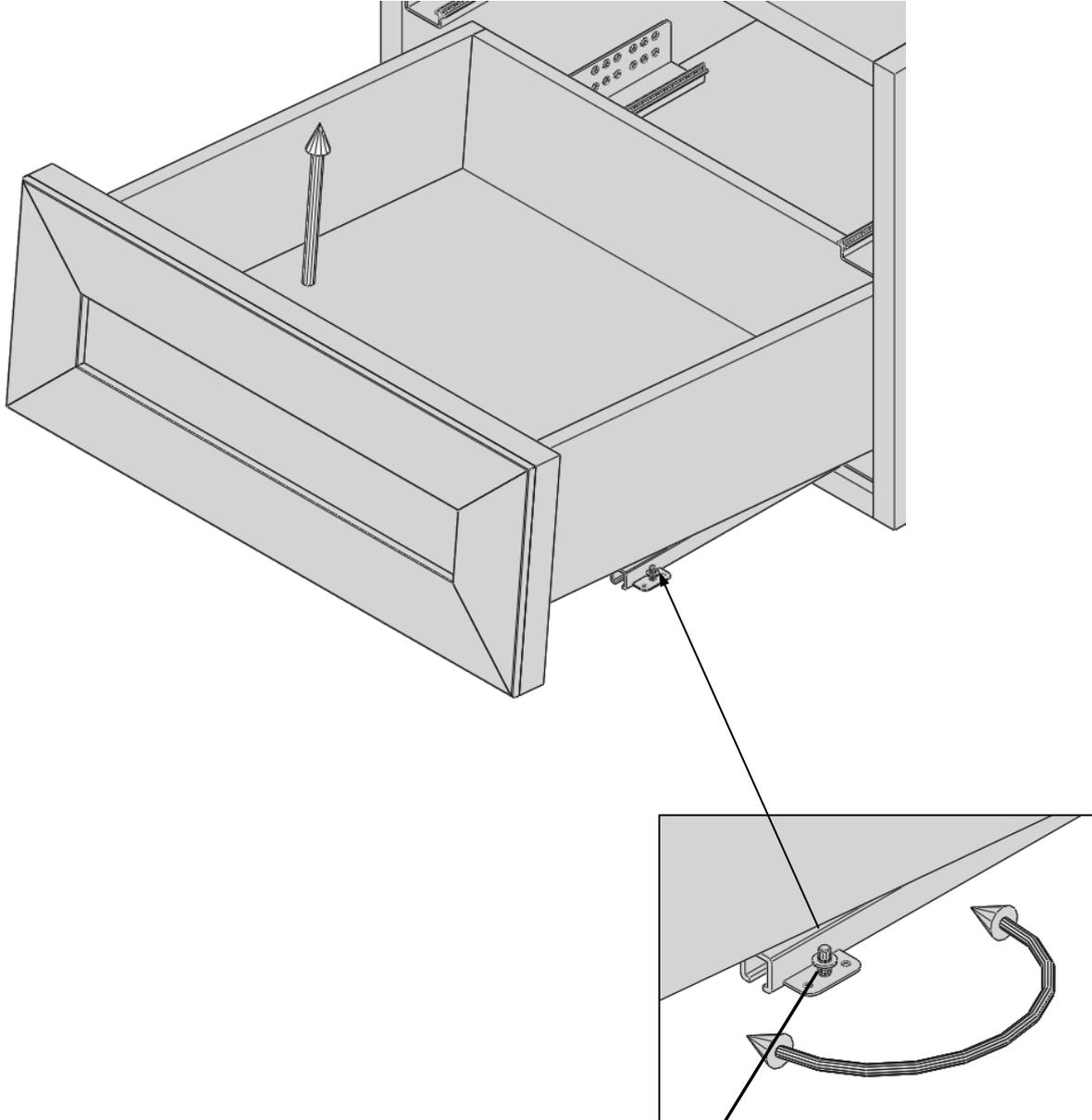
Heben Sie den Schubkasten im vorderen Bereich leicht aus. Verstellen Sie die Höhe durch das Drehen der Auflagescheibe am Sicherungsbolzen. Setzen Sie den Schubkasten nach dem Justieren wieder auf den Sicherungsbolzen.
