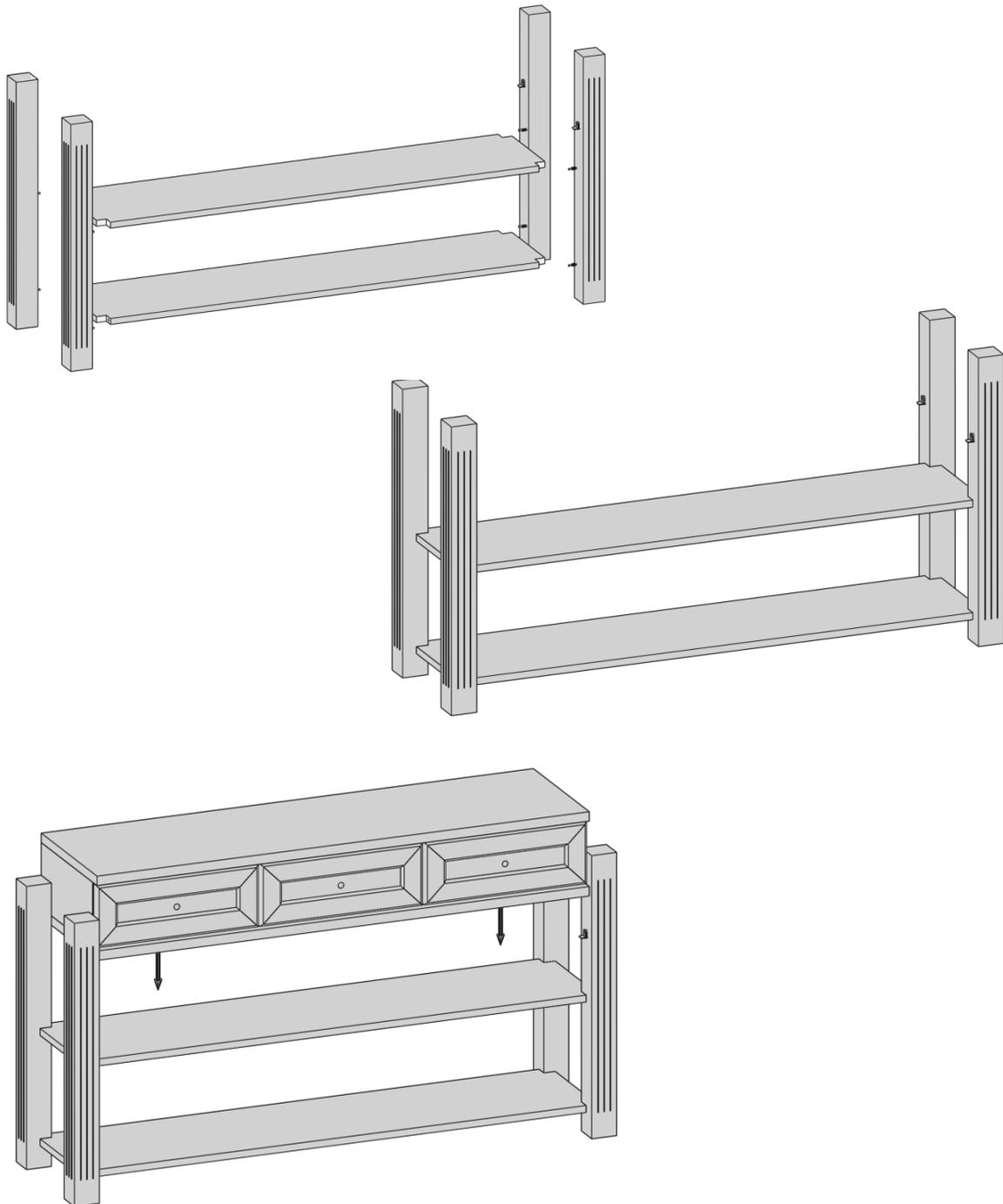
Stecken Sie den Boden mit den Füßen zusammen und Schließen Sie die Excentergehäuse. Nun hängen Sie den Korpus von oben auf die Einhängeschläge.
