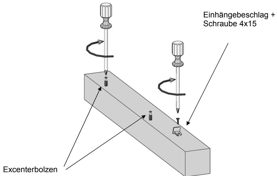
Schrauben Sie die Excenterbolzen in die 5mm und die Einhängebeschläge in die 3mm vorgebohrten Löcher.
