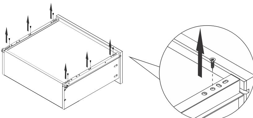
Zur Neu Befestigung der Schienen benutzen Sie die «querliegenden» Langlöcher vorne und hinten an den Schienen. Achten Sie dabei darauf, dass die Schubladenführungsschiene vorne an der Schubladenfront anliegt bzw. anstößt. Drücken Sie die Schiene fest an die Schubleadenseitenwange und die Schrauben anschließ
