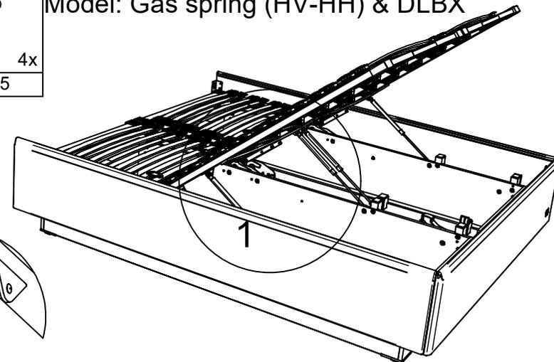
Federholzrahmen am Fußteilgriff öffnen. Transportbefestigung der Gasfeder entfernen und das Endstück auf den Kugelzapfen am Rahmen clipsen.
