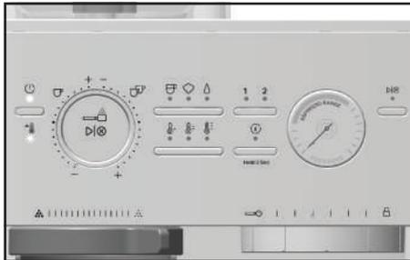
5. Spülen Sie den Brühkopf, und stellen Sie einen Behälter darunter. Wählen Sie mithilfe der Modus-Taste den Modus „Espresso“ aus. Stellen Sie die Dosiertaste auf 1 und drücken Sie die Start/Stopp-Taste für den Brühvorgang (▷|⊗). Das Gerät spült Wasser durch den Brühkopf und stoppt automatisch, wenn der Zyklus abgeschlossen ist.
