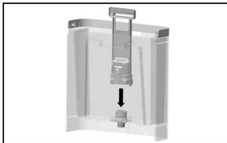
6. Setzen Sie den Wassertank ein, und befestigen Sie ihn.
