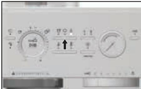
2. Halten Sie die Modus-Taste 3 Sekunden lang gedrückt, bis die LEDs für Espresso, Dampf und Heißwasser aufleuchten.
