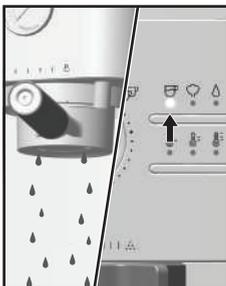
**Siebeinsatz spülen:** Halten Sie den Siebeinsatz sauber, um Verstopfungen zu vermeiden. Setzen Sie den Siebträger ohne gemahlene Kaffee in die Maschine ein und lassen Sie heißes Wasser durchfließen.
