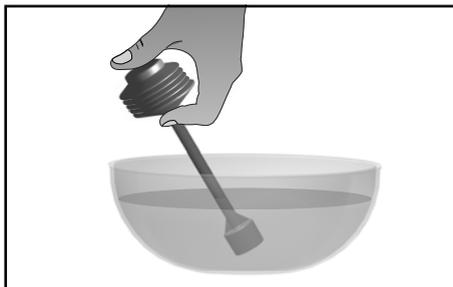
3. Halten Sie die Spülpumpe in vertikaler Position.
