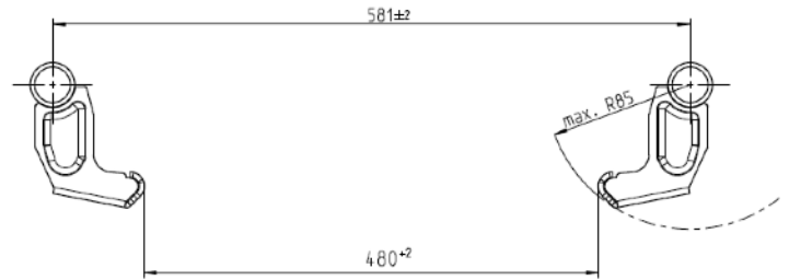
Abb. 12: Lage Motorhebel / Elektrobeschläge
