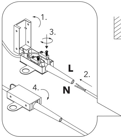
Weißer Kabelschutz vorsichtig mit Schlitzschraubenzieher öffnen.
