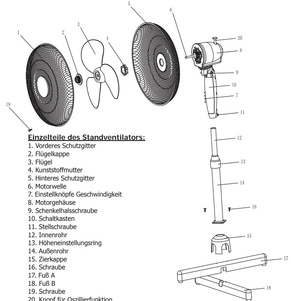
**Einzelteile des Standventilators:**
