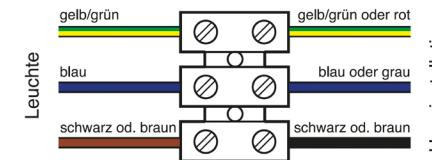
Bei einigen Leuchten muss der Schutzleiter nicht an eine Klemme angeschlossen werden, sondern an eine Klemme an Metallteilen der Leuchte (Schraube mit Erdungssymbol  $\oplus$ ).
