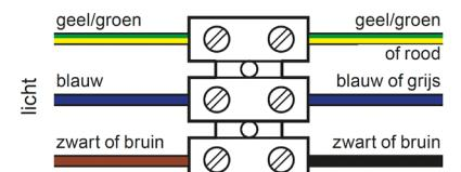
Bij een aantal lampen moet de aardleiding niet worden aangesloten op een klem, maar op een klem van de metalen delen van de lamp (schroef met aardingssymbool  $\ominus$ ).
