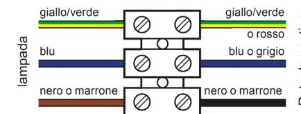
Per alcune lampade, il conduttore di terra non deve essere collegato a un terminale, ma a un terminale su parti metalliche della lampada (vite con simbolo di terra ⊕)
