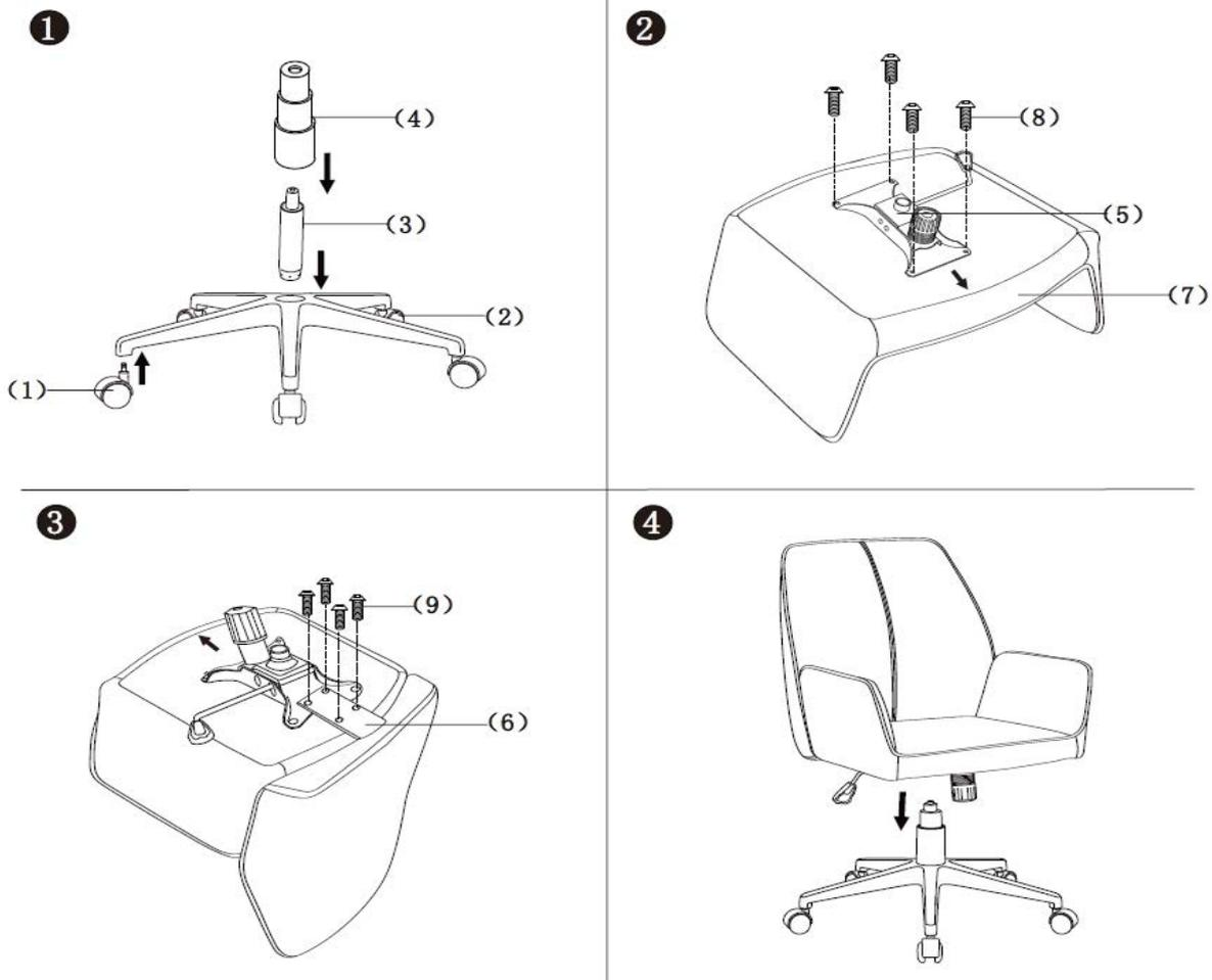
Nach der Montage setzen Sie sich bitte mehrfach hintereinander auf den Drehstuhl, damit sich die Verbindung zwischen Sitz, Gaslift und Fusskreuz verfestigt.
