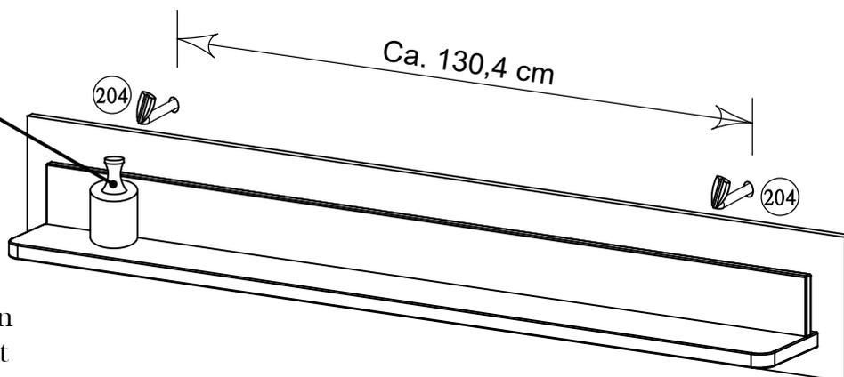
Die beigefügten Dübel zum Aufhängen des Elements dürfen nur bei Betonwänden eingesetzt werden, bei anderen Wandarten müssen entsprechende Dübel zugekauft werden.
