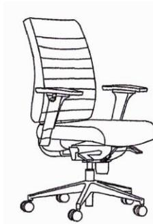
Nach der Montage setzen Sie sich bitte mehrfach hintereinander auf den Drehstuhl, damit sich die Verbindung zwischen Sitz, Gaslift und Fusskreuz verfestigt.
