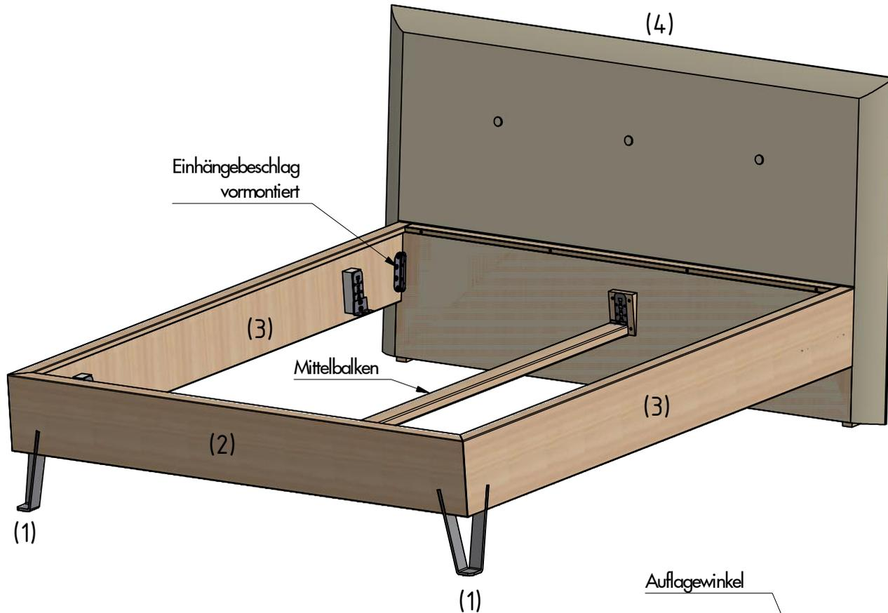
1. Bettfußteil (2) mit vormontierten Bettfußstollen (1) mit den Bettseiten (3) verschrauben. Die Position der Euroschrauben 6,3 x 16mm ist markiert.
