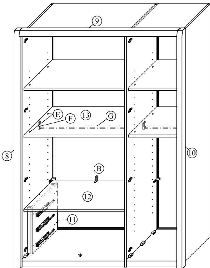
2. Linken Riegel (8) des Passepartout-Rahmens anstellen und durch die vorhandenen Löcher der Außenseite verschrauben. Oberen Riegel (9) auflegen, dicht an den linken Riegel schieben durch die vorhanden Löcher der Oberböden verschrauben. Rechten Riegel (10) anstellen, dicht an den oberen Riegel schieben und verschrauben.
