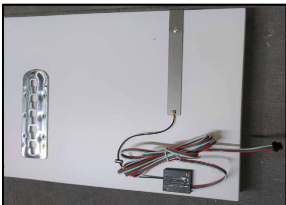
Winkelschalter an Bettseite verbaut
