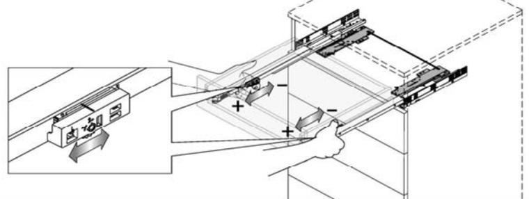
Auswurfkraft / Activation force / Force d'ouverture / Forza di sgancio / Fuerza de Activación / Öppningsimpuls / сила выталкивания
