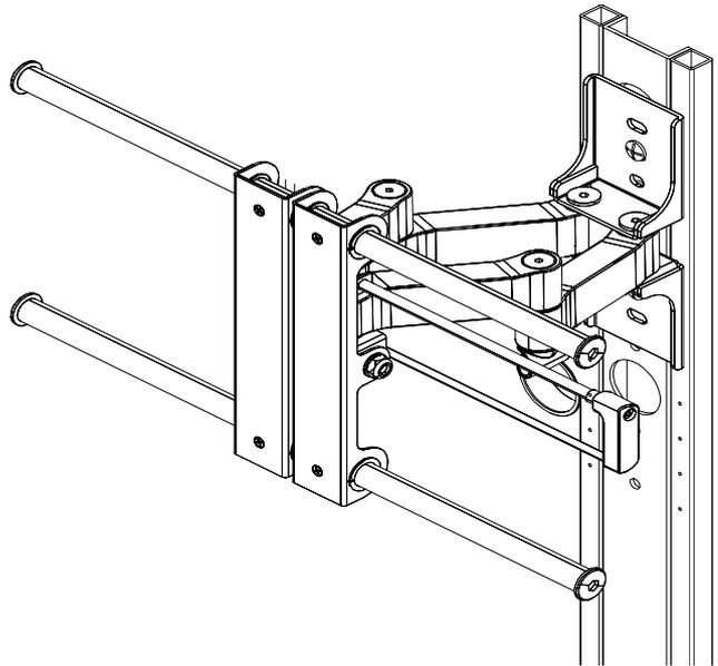
Beschlag / Fitting / Montaža / Felszerelés / Montaj / Vybavení / Vybavenie /
