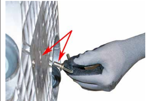
Bild/Picture 2.4 Stecken Sie die Senkschraube in die zentrale Bohrung und drehen Sie diese mit dem Sechskantschlüssel fest an. Achtung: Die Führungstifte des Aufnahmerohres müssen in den Bohrungen sein.
