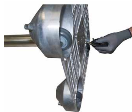
Bild/Picture 3 Druckfedern aufstecken Stecken Sie die 4 Druckfedern über die Bolzen des Ständergestells
