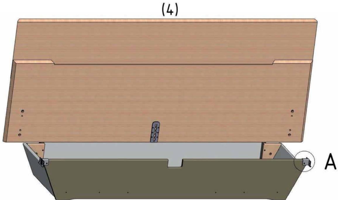
4. Jetzt können die Bettseiten (5) mit Hilfe des Maxifix Beschlages an das Bettkopfteil (4) montiert (4 x Maxifix Beschlag komplett, 4 Holzdübel 10x40 mm) und mit der Bettkopfteilblende verschraubt werden. (Position ist markiert Schraube 6,3x16)
