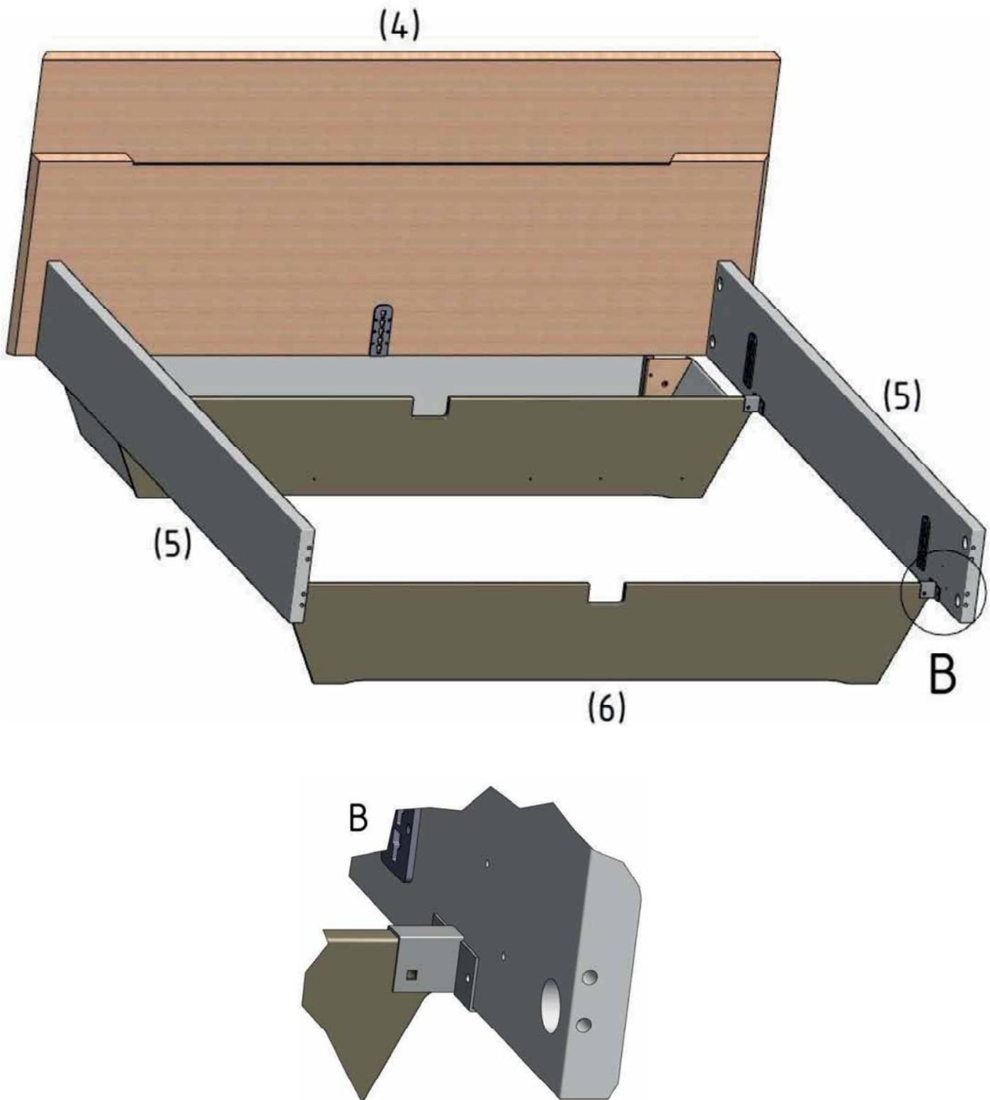
6. Die Bettfußteilblende (6) kann jetzt mit den Sockelverbindern an den Bettseiten (5) verschraubt werden. (Position ist markiert Schraube 6,3x16)
