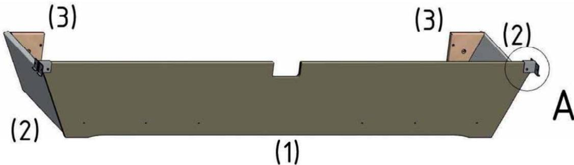
2. Oberhalb der Bettkopfteilblende (1) werden die Sockelverbinder montiert. (Flachrundschaube M6x40 und Flügelmutter, siehe Detail A)
