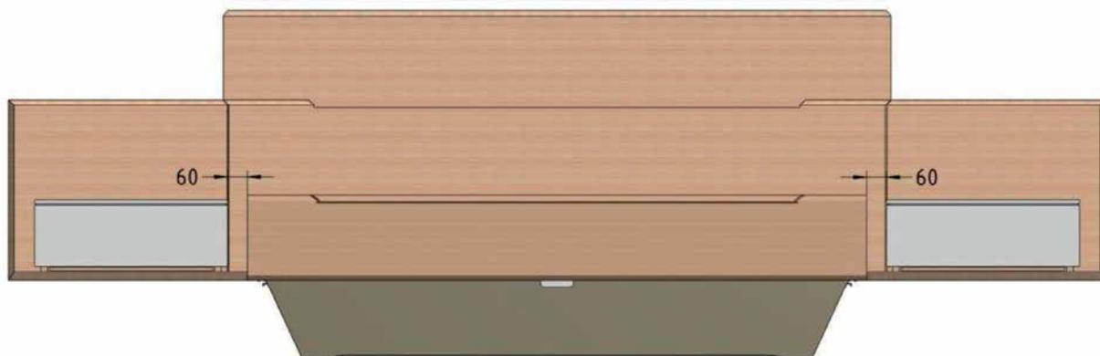
3. Anschließend wird die Konsole durch die vorgesehenen Bohrungen (2 x Rückwand und 2 x Unterboden) mit dem Paneel verschraubt (Schrauben 4 x 55).
