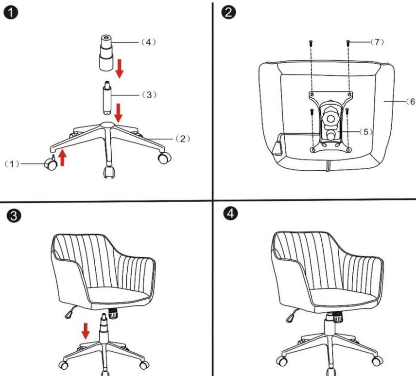
Nach der Montage setzen Sie sich bitte mehrfach hintereinander auf den Drehstuhl, damit sich die Verbindung zwischen Sitz, Gaslift und Fusskreuz verfestigt.
