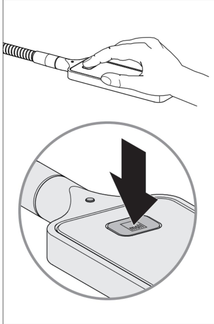
D Durch längeren Druck auf die Ein/Aus Taste, verändert diese kontinuierlich die Lichtfarbe. Die beliebig einstellbare Lichtfarbe wird automatisch abgespeichert, sobald der Benutzer die Taste loslässt. Diese Farbbeleuchtung der Taste, die immer aktiviert ist, auch wenn die LED Leuchte ausgeschaltet ist, dient als "Stimmungslicht" mit der nachts eine dezente farbige Beleuchtung des Raums möglich wird. Tagsüber dient die farbige Beleuchtung der Taste als Designelement.
