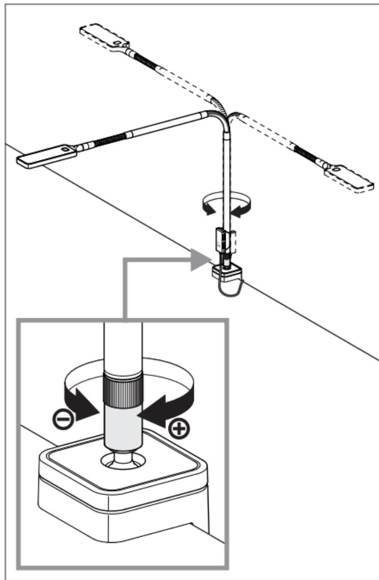
**D** Die Schwerkängigkeit der Drehachse ist einstellbar (wichtig bei schrägstellter Tischplatte).
