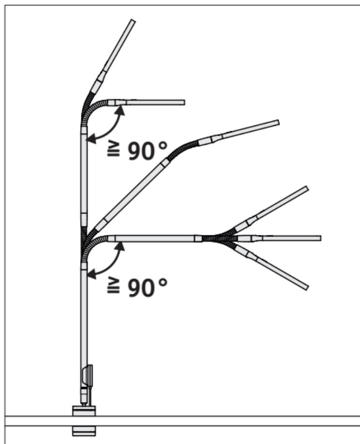
D Die flexiblen Gelenkelemente (Schwanenhälse) nie mehr als  $90^\circ$  knicken.
