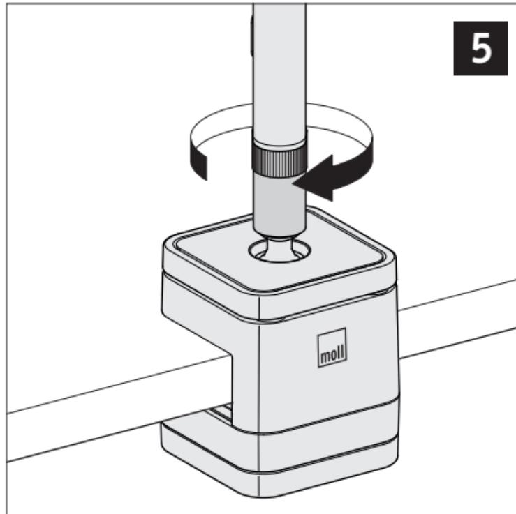
D **Die Schraube fest anziehen.** Die Schwergängigkeit der Drehachse ist einstellbar (wichtig bei schrägstellter Tischplatte), siehe S. 16
