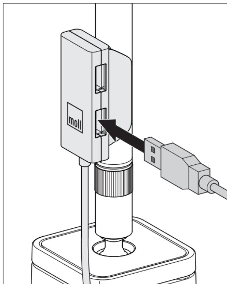
**D** Die USB-Einheit verfügt über 2 USB-Buchsen mit 5V Spannungsversorgung (max. 750 mA).
