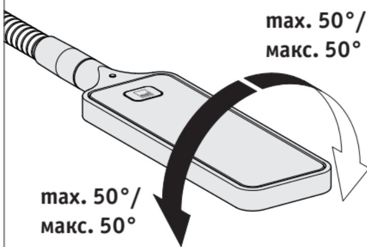
**D** Der Leuchtenkopf ist um max. 50° in beide Richtungen axial drehbar.
