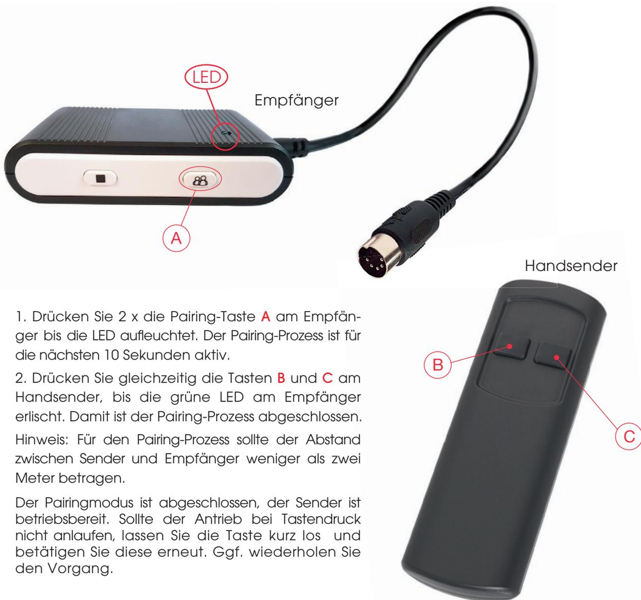
1. Drücken Sie 2 x die Pairing-Taste **A** am Empfänger bis die LED aufleuchtet. Der Pairing-Prozess ist für die nächsten 10 Sekunden aktiv.
