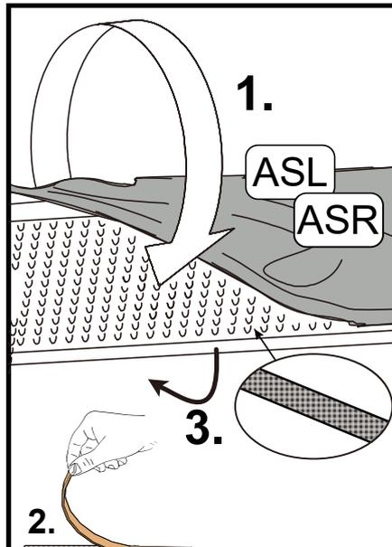
Verbinden Sie die Klettstreifen der Husse (ASL/ASR) mit dem Gegenprofil am Kopfteil, Vorder- und Unterseite (1/5).
