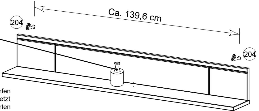
Die beigefügten Dübel zum Aufhängen des Elements dürfen nur bei Betonwänden eingesetzt werden, bei anderen Wandarten müssen entsprechende Dübel zugekauft werden.
