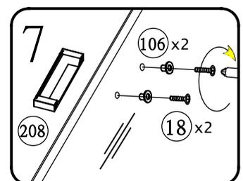
Die beigefügten Dübel zum Aufhängen des Elements dürfen nur bei Betonwänden eingesetzt werden, bei anderen Wandarten müssen entsprechende Dübel zugekauft werden.
