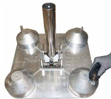
Bild/Picture 3 Druckfedern aufstecken Stecken Sie die 4 Druckfedern über die Bolzen des Ständergestells
