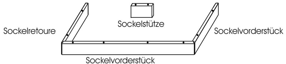
1. Montieren Sie die Sockel-Retouren mit dem Sockelvorderstück. Hierzu stecken Sie jeweils einen Excenter und zwei Dübel (Ø8x30) in die Sockel-Retouren. Schrauben Sie in das Sockelvorderstück links und rechts einen Einschraubbolzen ein. (Abb. 1)
