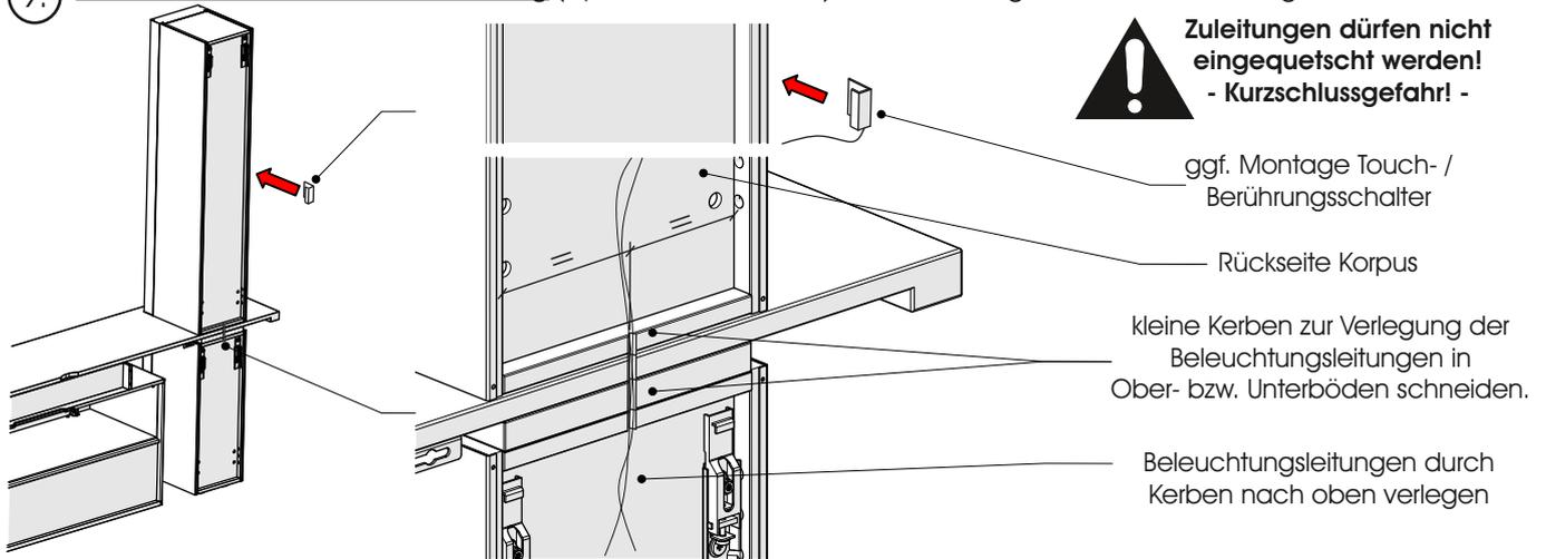
10. Unteres Korpus-Element positionieren und ausrichten
