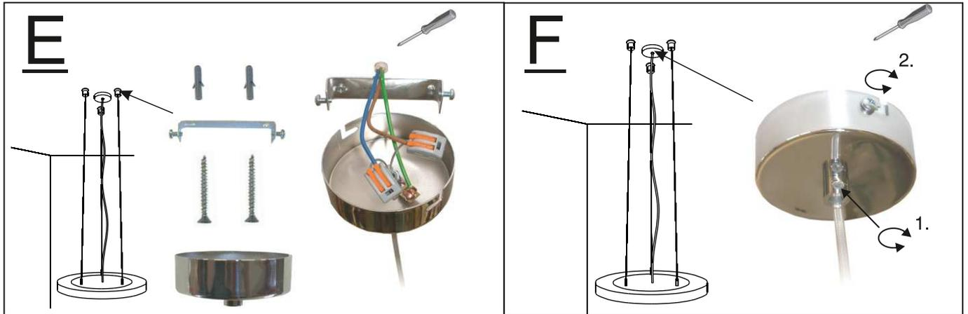
Wir empfehlen Ihnen eine Montagehöhe der Lampe von 1,7m bis 1,8m vom Fußboden. Bei der Montage von zwei Leuchten je Tisch sollten diese mit einer Differenz von ca. 10cm höhenversetzt angebracht werden. Hierdurch erhält man eine gefälligere Ansicht.
