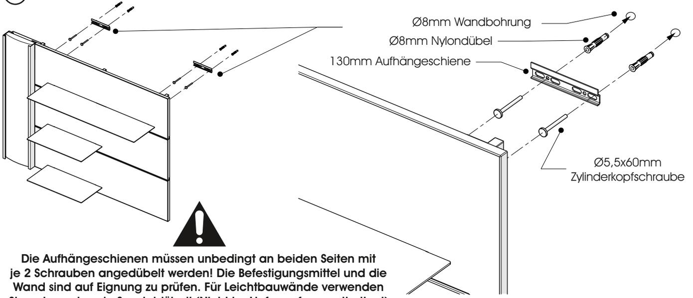
Die Aufhängeschienen müssen unbedingt an beiden Seiten mit je 2 Schrauben angedübelt werden! Die Befestigungsmittel und die Wand sind auf Eignung zu prüfen. Für Leichtbauwände verwenden Sie entsprechende Spezialdübel! (Nicht im Lieferumfang enthalten!)
