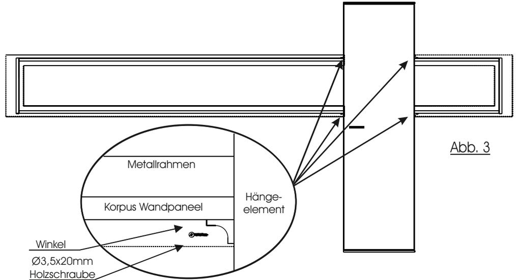
6. Die Metallböden der Wandpaneele müssen am Hängeelement fixiert werden. Hierzu wird an beiden Seiten des Hängeelement unterhalb der Metallböden die Abkantung verschraubt. Hierzu prüfen Sie zunächst den Winkel des Bodens und zeichnen ggf. leicht an. (Abb. 4A)
