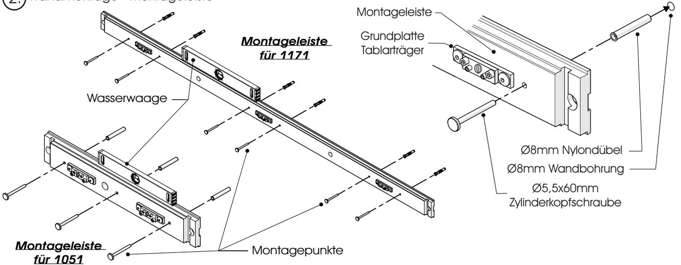
**! Die Montageleiste muss an jedem hierfür vorgesehenen Montagepunkt an die Wand befestigt werden. Die Befestigungsmittel und die Wand sind auf Eignung zu prüfen. Für Leichtbauwände verwenden Sie entsprechende Spezialdübel! (Nicht im Lieferumfang enthalten!) !**
