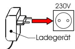
Bei Bedarf AKKU durch Anschluss des Ladegeräts an Buchse laden
