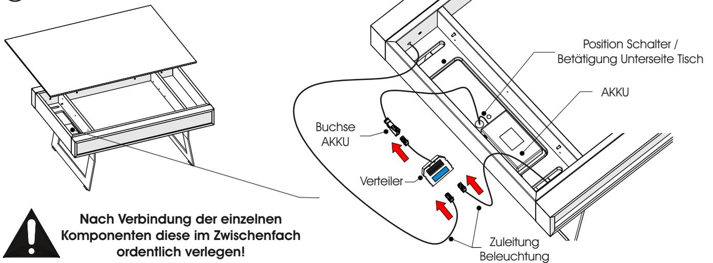
5. **Nur bei Beleuchtung:** Positionswechsel der Bodenträger für Zwischenboden / AKKU-Einheit einschalten
