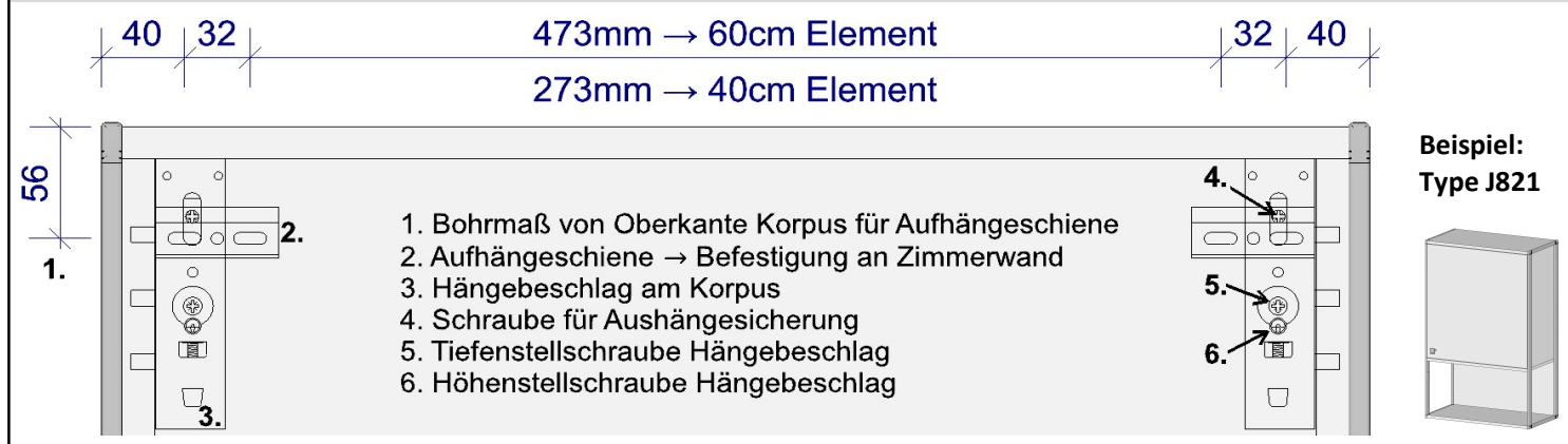
Abbildung 2: Bohrmaße für Aufhängeschienen Teil-Nr. 50811 mit Elementbreite 40cm
