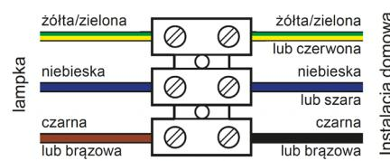
W niektórych lampkach przewód ochronny musi być podłączony nie do zacisku, lecz do zacisku na częściach metalowych lampki (śrubka z symbolem uziemienia).
