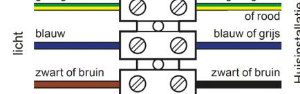
Bij een aantal lampen moet de aardleiding niet worden aangesloten op een klem, maar op een klem van de metalen delen van de lamp (scherf met aardingssymbool
