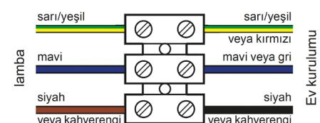
Bazı lambalarda koruyucu iletkenin klemense bağlanması gereklidir, bunun yerine lambanın metal parçalarındaki bir klemense bağlanır (topraklama sembollü vidası).
