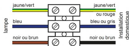
Pour certaines lampes, le conducteur de protection ne doit pas être branché sur une borne, mais sur une borne sur des pièces métalliques de la lampe (vis avec symbole de mise à la terre ⊕).
