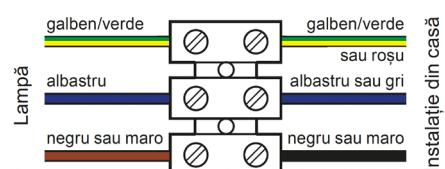
În cazul anumitor lămpi conductorul de protecție nu trebuie conectat la o bornă, ci la clema de la componente metalice ale lămpii (șurub cu simbolul de pământare ⊕).
