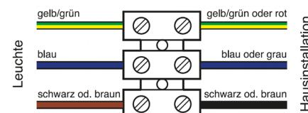
Bei einigen Leuchten muss der Schutzleiter nicht an eine Klemme angeschlossen werden, sondern an eine Klemme an Metallteilen der Leuchte (Schraube mit Erdungssymbol ).
