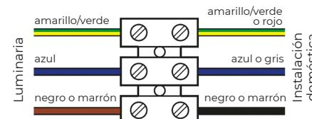
Vissa lampor kräver skyddsledaren inte kopplas till en terminal, utan till en terminal på metallar av lampan (skruv med jordningssymbol ).
