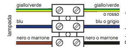
Per alcune lampade, il conduttore di terra non deve essere collegato a un terminale, ma a un terminale su parti metalliche della lampada (vite con simbolo di terra ⊕)
