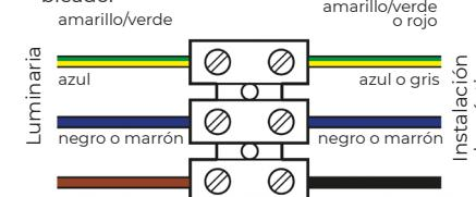
En algunas luminarias, el conductor de protección no debe conectarse a un borne, sino a un borne situado en las partes metálicas de la luminaria (tornillo con símbolo de toma de tierra ).
