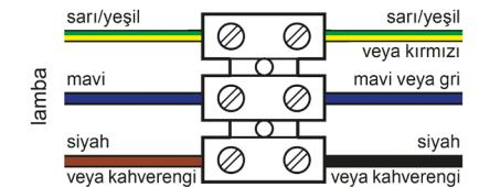
Bazı lambalarda koruyucu iletkenin klemense bağlanması gereklidir, bunun yerine lambanın metal parçalarındaki bir klemense bağlanır (topraklama sembollü veda ).
