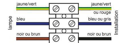
Pour certaines lampes, le conducteur de protection ne doit pas être branché sur une borne, mais sur une borne sur des pièces métalliques de la lampe (vis avec symbole de mise à la terre ).
